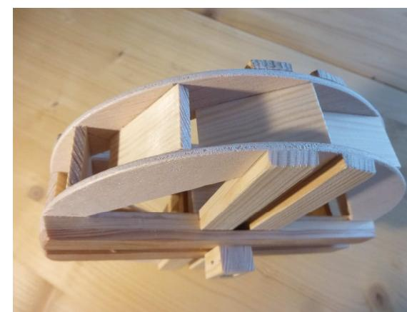
**Das Wasserrad** (Zuerst zwei Holzscheiben ausschneiden, Querleisten anpassen und 12 kleine Leistenstücke zwischen die Scheiben leimen.
