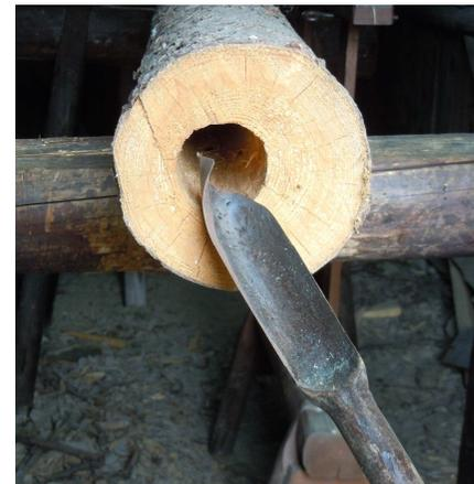
Wasserröhre und Löffelbohrer
